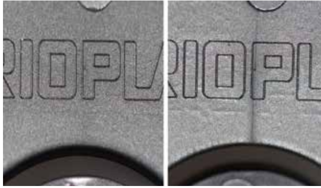
Bild 3. Oberfläche eines Formteils mit (links) und ohne (rechts) Einsatz von Turbotherm. Einmal ist keine Bindenaht sichtbar, im anderen Fall schon (© Varioplast)
