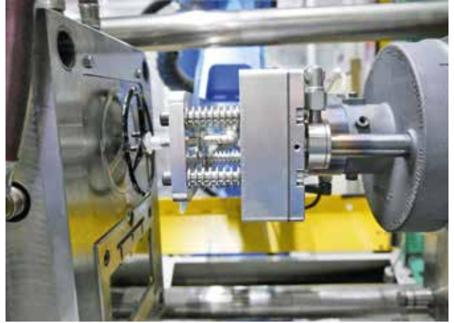
Bild 1. Im Serieneinsatz wird auf der Auswerferseite das fertige Teil entnommen, während parallel auf der Düsen- seite die Kavität aufgeheizt wird (links). Das 3D-gedruckte metallische Heizkopfmodul (rechts) ermöglicht eine schnelle Anpassung an kundenspezifische Geometrien im Werkzeug © Varioplast
