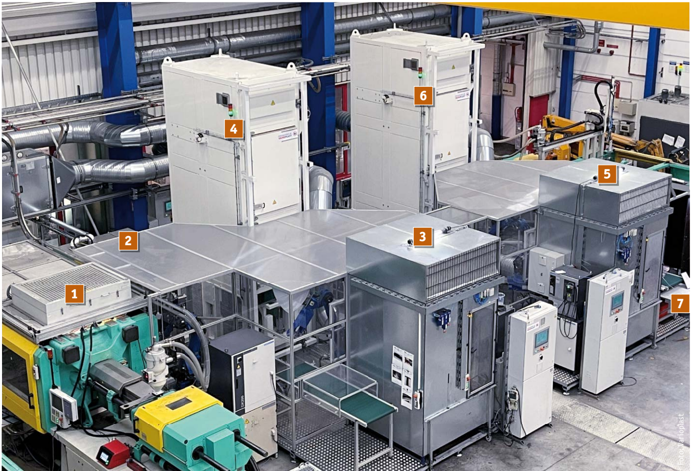
Inline-Verknüpfung aller Prozessschritte über u.a. sechs Knickarmroboter: 1 Spritzguss, 2 CO 2 -Vorreinigung, 3 Grundierung, 4 Trocknung, 5 Effektlackierung, 6 Trocknung, 7 Sichtkontrolle durch Werker.
