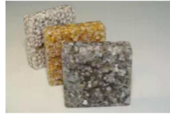
Musterplatten mit unterschiedlichen Füllstoffen (Bild: Varioplast)
